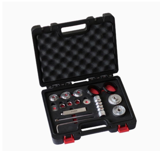
CEMA 中轴拆装工具
